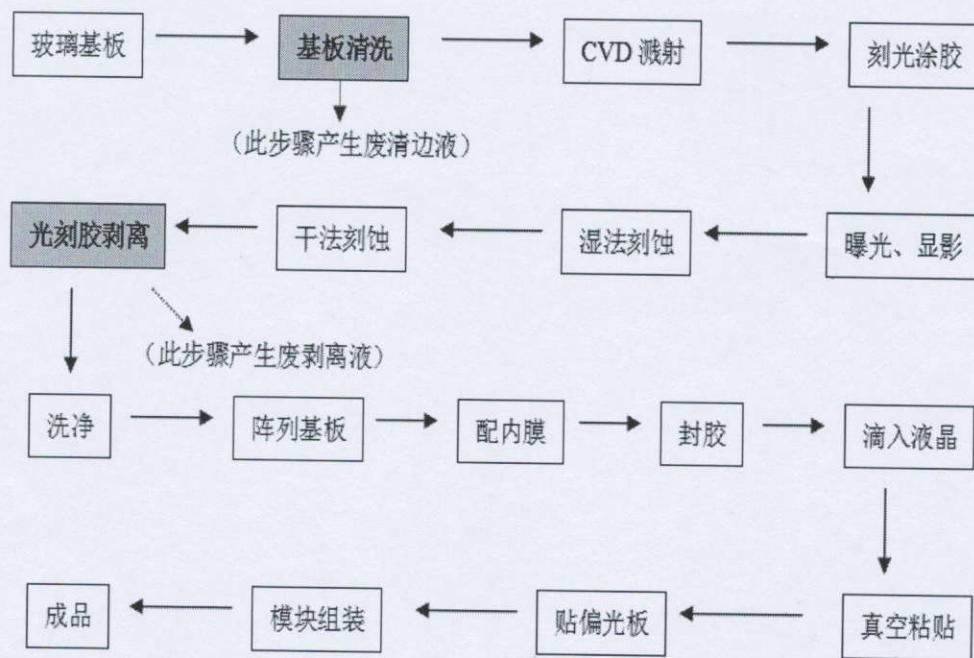
液晶显示屏生产工艺为：玻璃基板—基板清洗（废清边液产生环节）—CVD 溅射—刻光涂胶—曝光、显影—湿法刻蚀—干法刻蚀—光刻胶剥离（废剥离液产生环节）—洗净—阵列基板—配向膜—封胶—滴入液晶—真空粘贴—贴偏光板—模块组装—成品。
