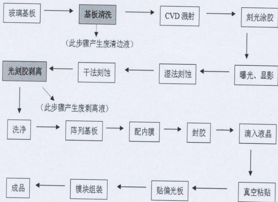
液晶显示屏生产工艺为：玻璃基板—基板清洗（废清边液产生环节）—CVD 溅射—刻光涂胶—曝光、显影—湿法刻蚀—干法刻蚀—光刻胶剥离（废剥离液产生环节）—洗净—阵列基板—配向膜—封胶—滴入液晶—真空粘贴—贴偏光板—模块组装—成品。
