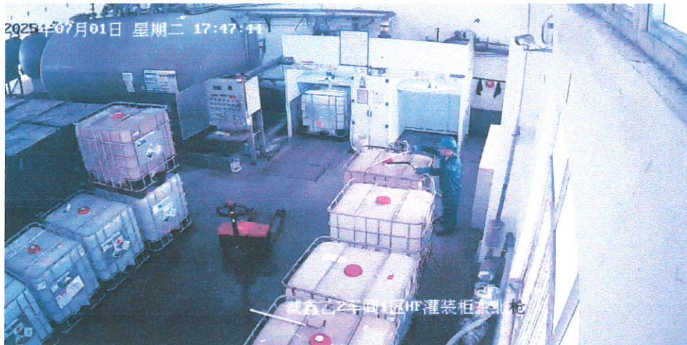
图8 隔膜泵入口管拔离不良品桶液面与桶口斜贴固定
