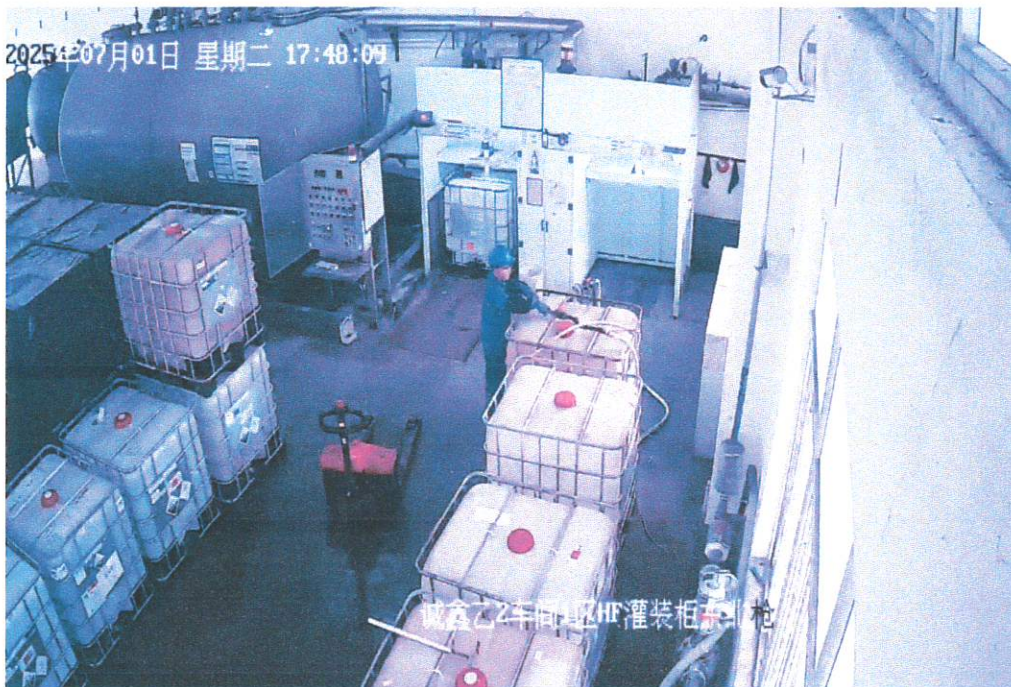
图9 隔膜泵出口管从灌装柜内侧挂勾取下插入不良品桶，与桶框架捆绑固定
