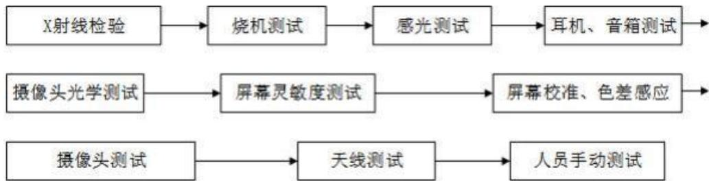
**图 2-9 测试工段工艺流程及产污环节**
